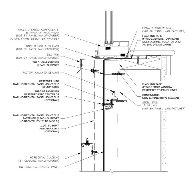
HORIZONTAL PANEL JOINT CLIP SILL BW UNIVERSAL SYSTEM<sup>TM</sup> DRAWING NO:
