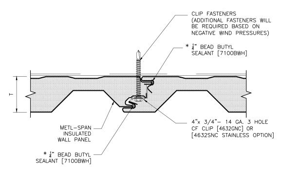
\* SIDE JOINT SEALANT MAY BE INSTALLED IN EITHER THE FIELD OR THE FACTORY
