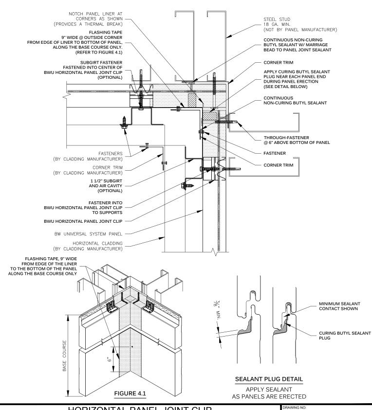
HORIZONTAL PANEL JOINT CLIP INSIDE CORNER BW UNIVERSAL SYSTEM<sup>TM</sup>
