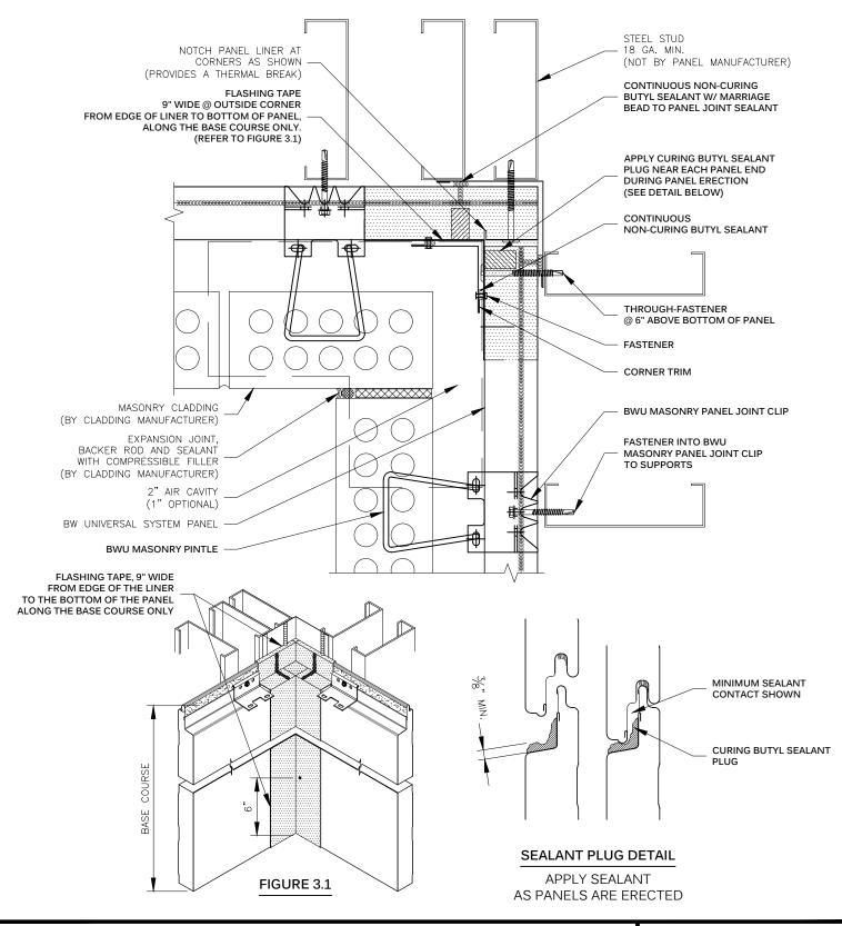
MASONRY PANEL JOINT CLIP INSIDE CORNER BW UNIVERSAL SYSTEM<sup>TM</sup> DRAWING NO:
