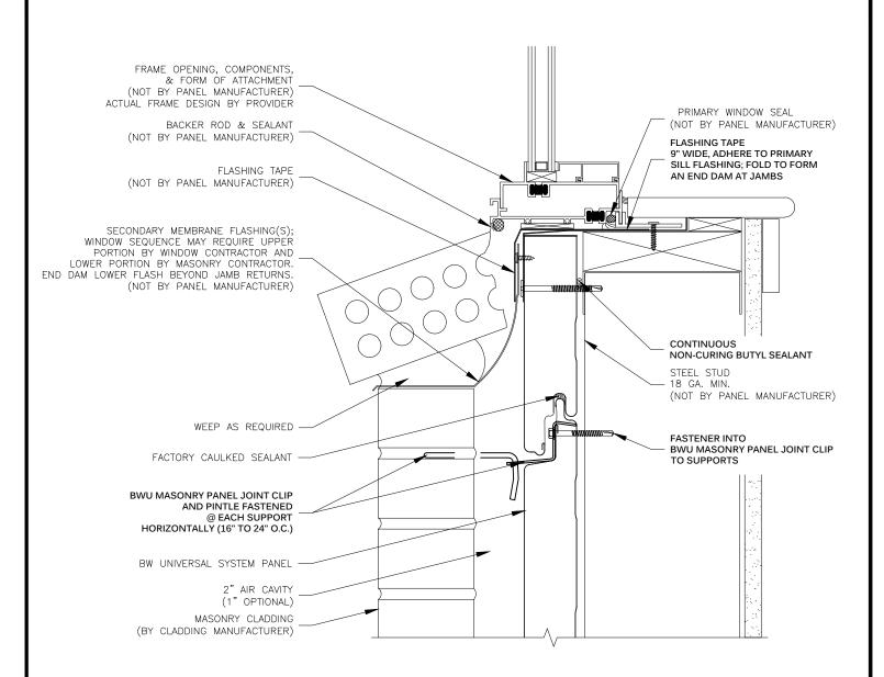
MASONRY PANEL JOINT CLIP SILL BW UNIVERSAL SYSTEM<sup>TM</sup>
