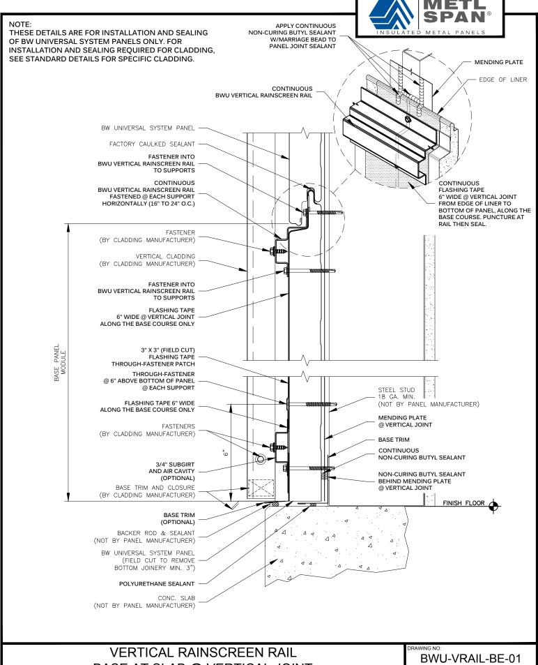
BASE AT SLAB @ VERTICAL JOINT BW UNIVERSAL SYSTEM<sup>TM</sup>
