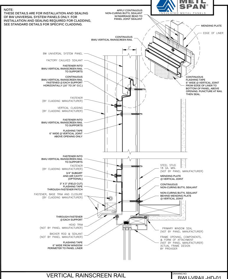
**HEADER @ VERTICAL JOINT** BW UNIVERSAL SYSTEM<sup>TM</sup>
