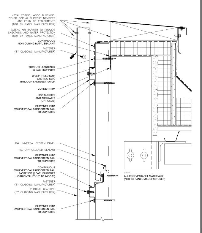
VERTICAL RAINSCREEN RAIL PARAPET BW UNIVERSAL SYSTEM<sup>TM</sup>
