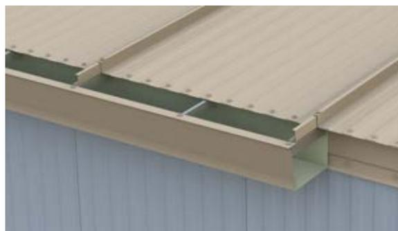
LOS PANELES CFR DE 107 CM REQUIEREN SOPORTES PARA LA CANALETA INTERMEDIA AL UTILIZAR LA CANALETA DEL NORTE.
