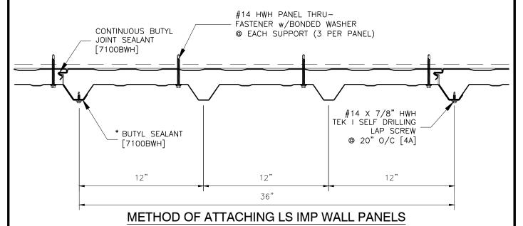
\* APPLIES ONLY WHEN AN EXTERIOR VAPOR BARRIER IS REQUIRED
